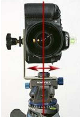
Drehachse mit optischem Zentrum zur Deckung bringen
