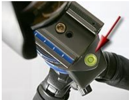
Horizontale Ausrichtung mittels Kugelkopf
