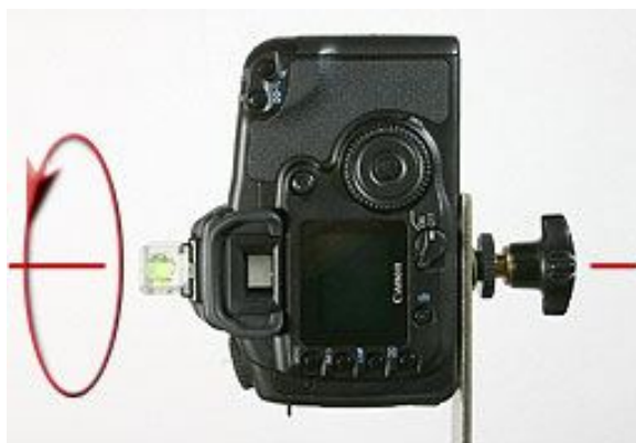
Vertikale Ausrichtung am Hochformatwinkel
