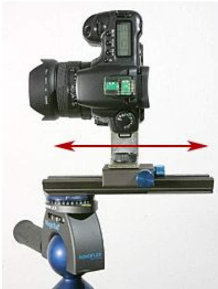
Drehachse ins optische Zentrum verschieben
